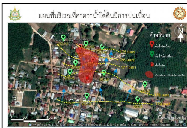
รูปที่ 3.5 บริเวณที่คาดว่าน้ำใต้ดินมีการปนเปื้อน และทิศทางการไหลของน้ำใต้ดิน
